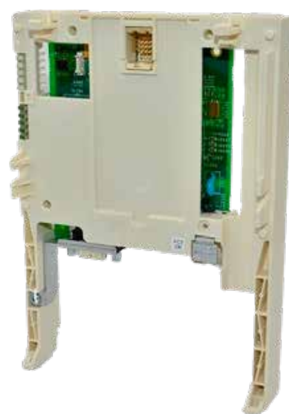
Tarjeta de comunicación para ATV61 ATV71 - 1 Mbps
